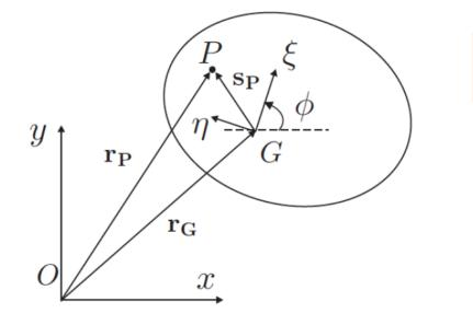
$$A = \begin{bmatrix} \cos \phi & -\sin \phi \\ \sin \phi & \cos \phi \end{bmatrix}$$
